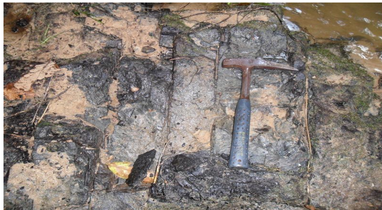
Gambar 4.19. Kenampakan bidang-bidang cleat pada LP 48
