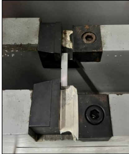
Gambar 4. 2 Posisi spesimen pada mesin
