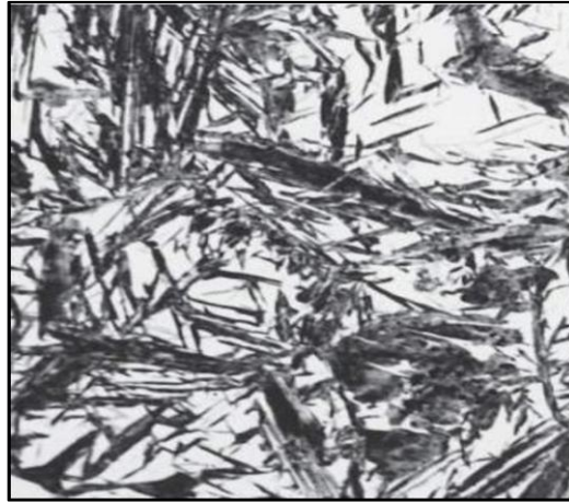
Gambar 2. 11 Struktur Mikro Martensit (Callister Jr & Rethwisch, 2018)
