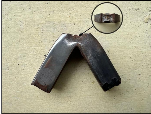
Gambar 4. 4 Hasil Pengujian Impak Spesimen Austempering 400 °C, 1000'
