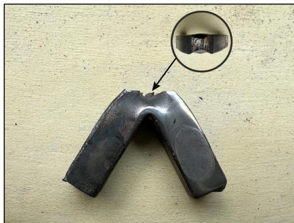
Gambar 4. 3 Hasil Pengujian Impak Spesimen Austempering 400 °C, 60'
