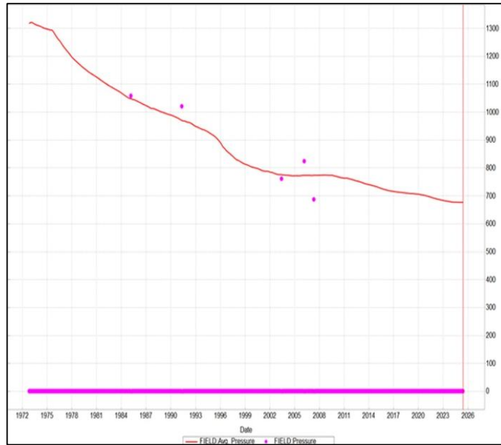
Gambar 4. 21. Kurva Pressure Hasil History Matching pada Lapangan "AAN" Lapisan "AB"
