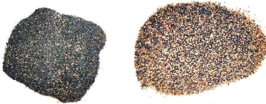
Gambar III.6 Produk Konsentrasi Magnetik, Konsentrat (kiri) dan *Tailing* (kanan)
