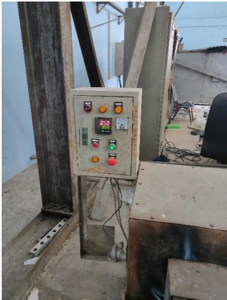
Gambar A.13 Pengaturan Suhu *Furnace*
