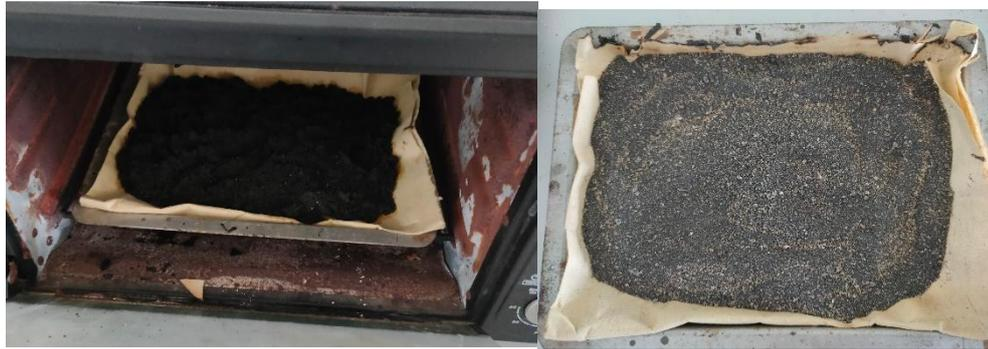
Gambar III.4 Proses Pengeringan Sampel *Raw* Pasir Ilmenite
