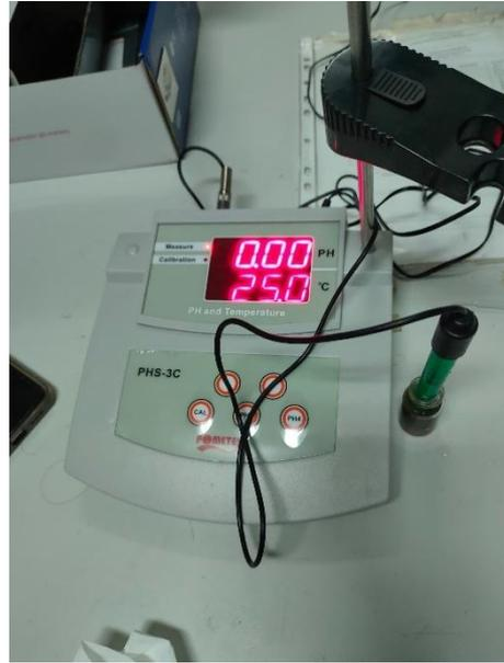
Gambar A.26 Pengukuran pH Filtrat
