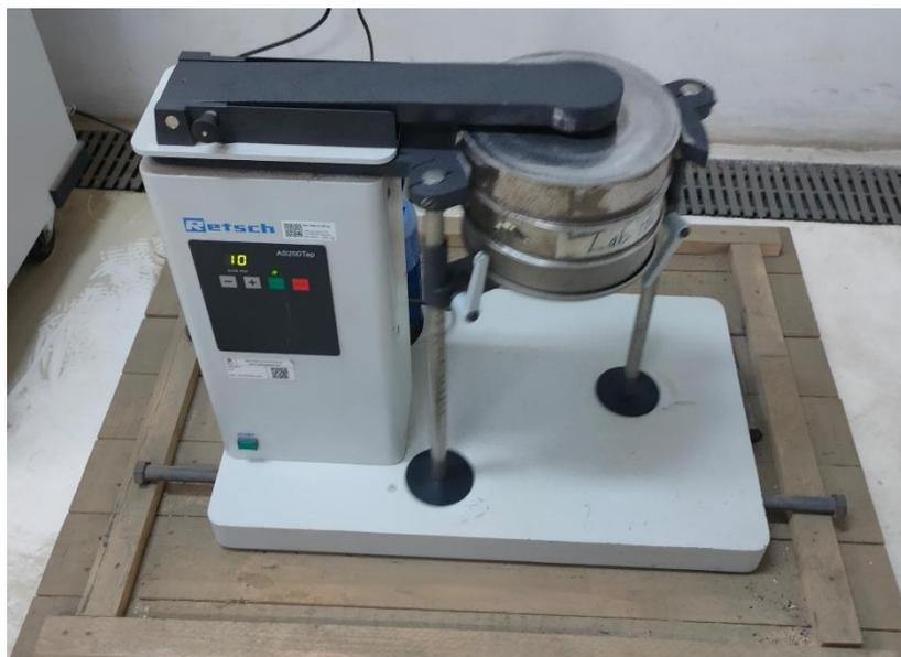
Gambar III.5 Proses Pengayakan Sampel *Raw* Pasir Ilmenite
