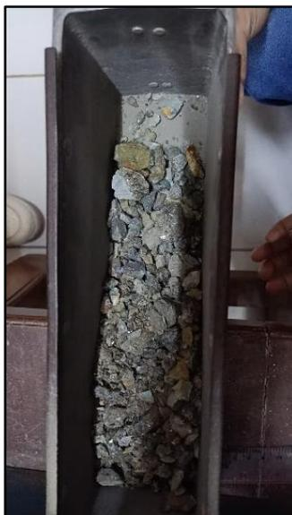
**Gambar 2.** Hasil *Jaw Crusher Retsch Type BB1 Masch Nr 71111*
