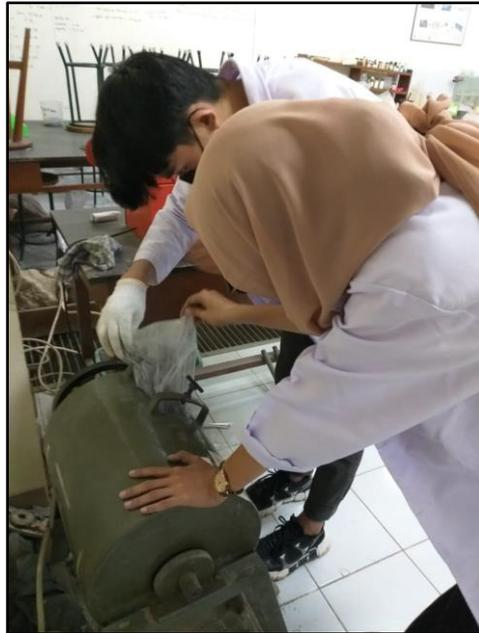
**Gambar 3.** *Rod mill* dengan media gerus berupa batang baja.
