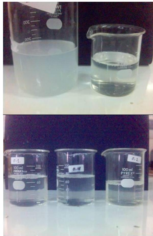
Gambar 7. Kondisi Larutan Surfactant Setelah Core Flooding-2 Test. (Atas) Surfactant SS B8020 Konsentrasi 0,3 % Dibandingkan Dengan Jenis Lain; (Bawah) Surfactant SS B8020 Konsentrasi 0,1-0,2 % Setelah Core Flooding Test
