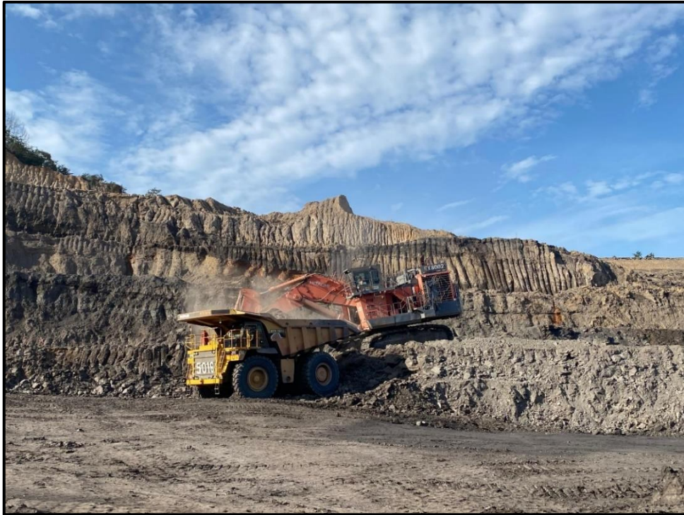
Gambar 4.4 Pola Pemuatan Top Loading dengan teknik Single Back Up
