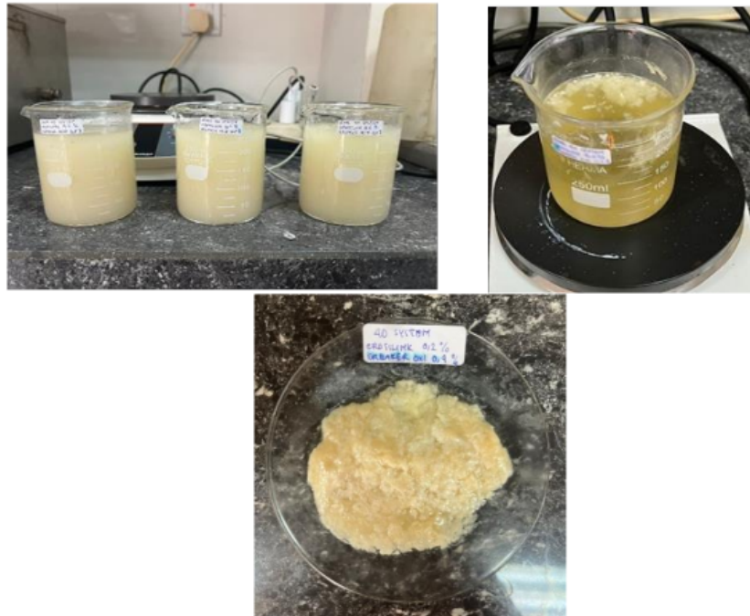
Gambar 4.1 Fluida perekah secara visual (a) sebelum break, (b) setelah break, (c) residu yang dihasilkan
