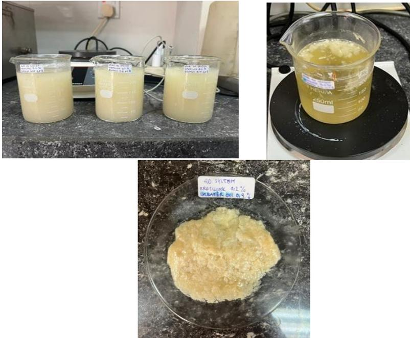
Gambar 4.1 Fluida perakah secara visual (a) sebelum break, (b) setelah break, (c) residu yang dihasilkan
