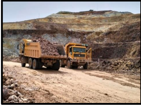
Gambar 2.10 Proses Pengangkutan Material Ore menuju HLP
