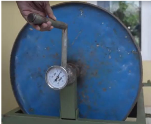
Gambar 9 Tuas dan Pengatur Suhu Rotary Drum Pyrolizer
