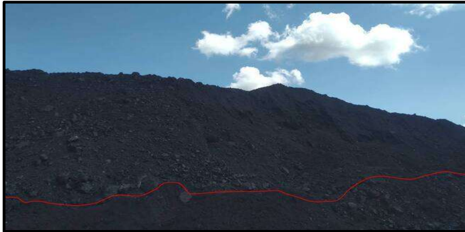
Gambar 4.9 Timbunan Double Bench Pada ROM Stockpile
