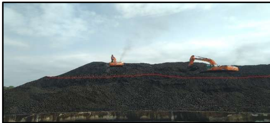
Gambar 4.11 Timbunan Double Bench Pada Product Stockpile
