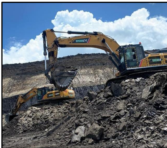
Gambar 2.5 Kegiatan Pembongkaran Overburden menggunakan Alat Gali Muat
