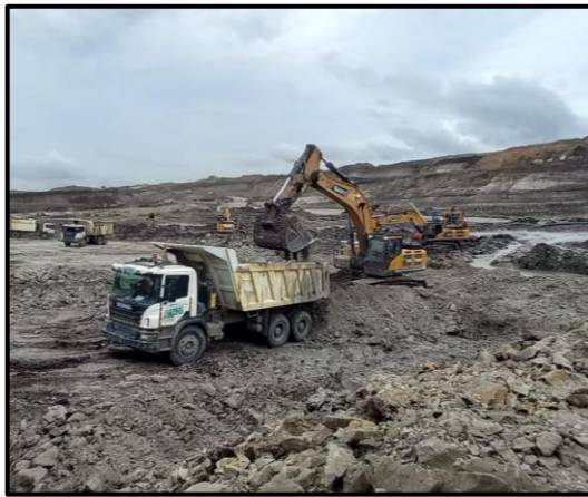
Gambar 2.6 Kegiatan Pemuatan Overburden oleh Alat Gali Muat ke Alat Angkut
