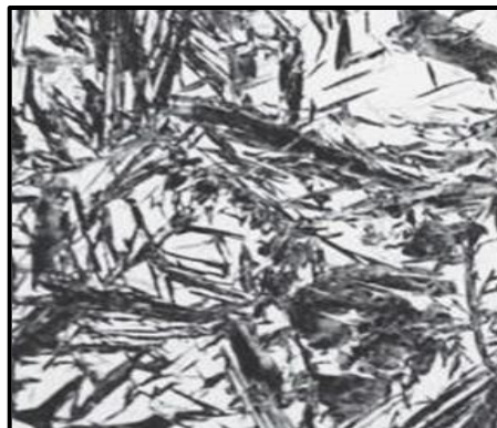
Gambar 2.13 Struktur Fasa Martensit (90x)
