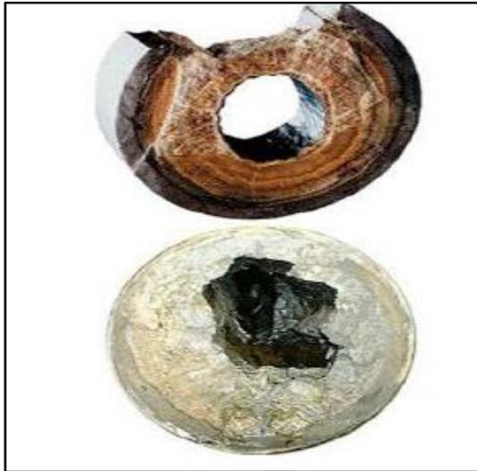
**Gambar 14. Deposisi *Scale* pada Dinding Sumur**
