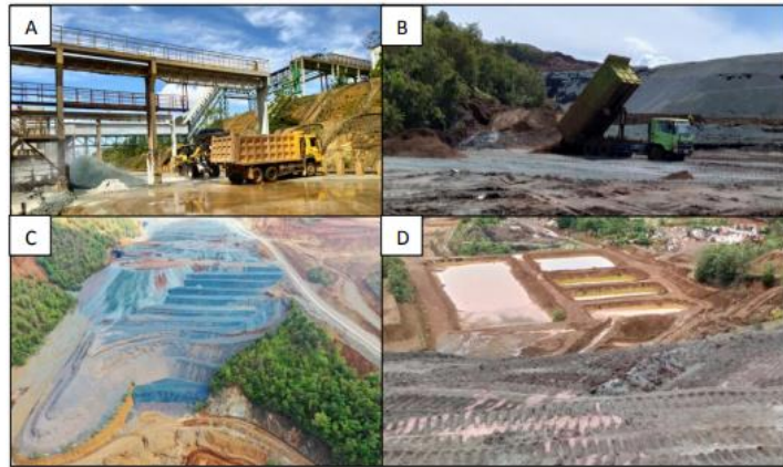
GAMBAR 3. Pengelolaan Sisa Pemanfaatan Slag Nikel; A). Loading Slag Nickel dari Slag Pool ke truck, B). Fasilitas penimbunan Pit Raja Ampat, C). Penataan slag nikel pada Pit Raja Ampat, dan D). IPAL Slag Nikel
