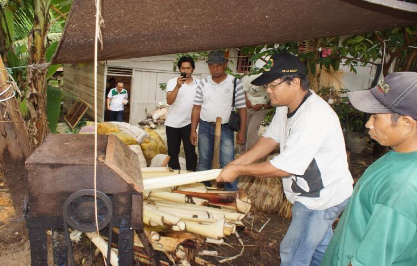
Proses memasukkan pelepah ke mesin penghancur/penggiling.
