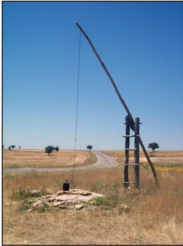
Gambar 10. Ilustrasi Shadouf Tradisional (Tikkanen, n.d.)
