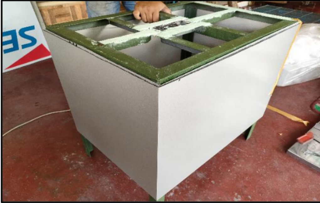
Gambar 19. Dinding alat TTG menggunakan aluminium
