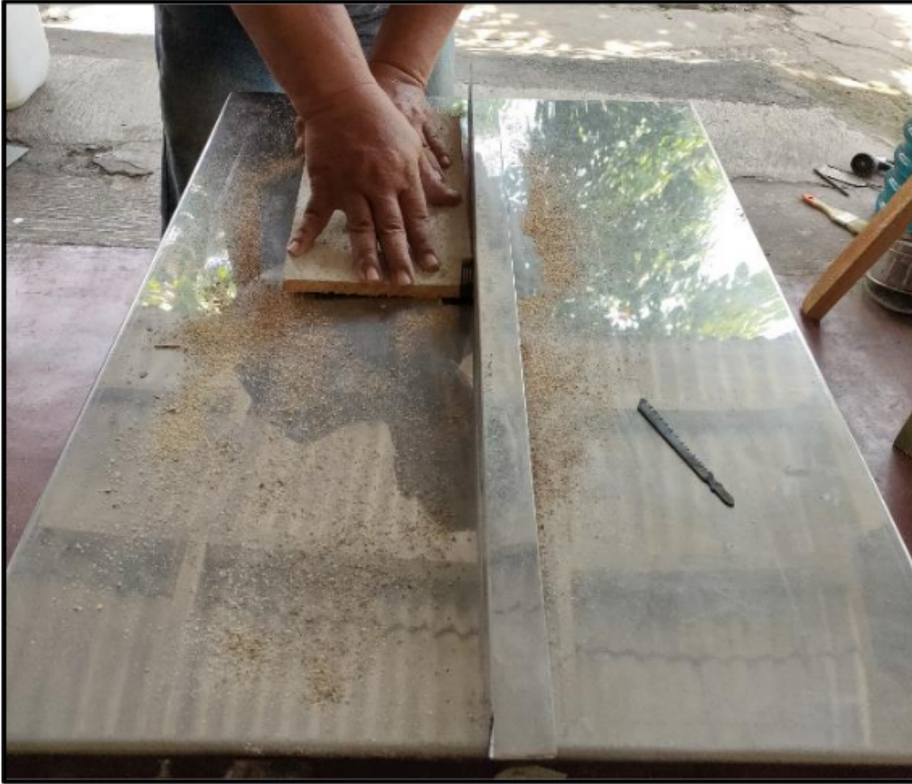
Gambar 21. Uji coba alat pemotong gagang kipas kayu
