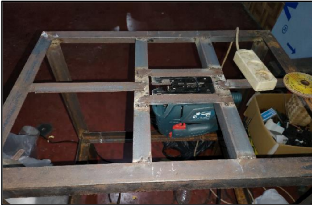
Gambar 18. Pemasangan mesin Jigsaw pada kerangka
