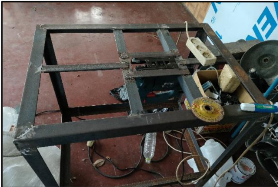
Gambar 16. Kerangka mesin TTG untuk pemotong gagang kipas
