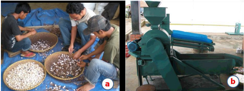
Gambar 24. Pemisahan kernel dari biji secara manual (a) dan menggunakan mesin dekortikator (b)
