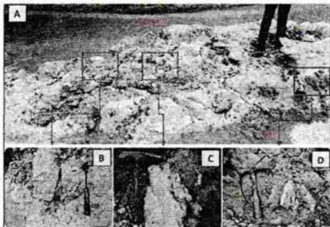
Gambar 1.6. (a) Kenampakan singkapan tipe alterasi argilik pada lokasi pengamatan 9 (Koordinat: X: 278872, Y: 9179848, Elevasi 160 m), (b) kenampakan kumpulan dominasi mineral lempung ( clay ), (c) urat kuarsa yang mengandung mineral sulfida berupa pirit, (d) urat kuarsa yang tertanam pada tubuh batuan yang didominasi mineral lempung.
