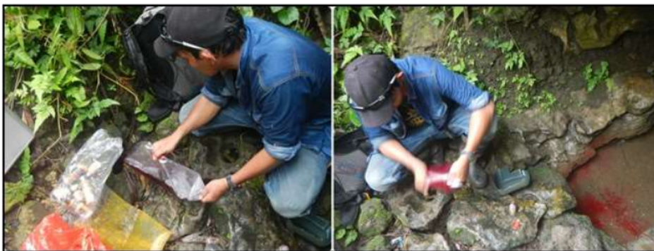
foto 4. Kenampakan aktivitas kegiatan water tracing dilokasi mataair rekahan Sirumpit dengan menggunakan alat dan bahan yang telah disiapkan.
