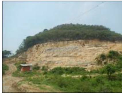
Foto 3. Foto kenampakan satuan sisipan lempung-serpih karbonatan pada satuan batugamping-kalkarenitan di area extension PT. Holcim Indonesia, Tbk
