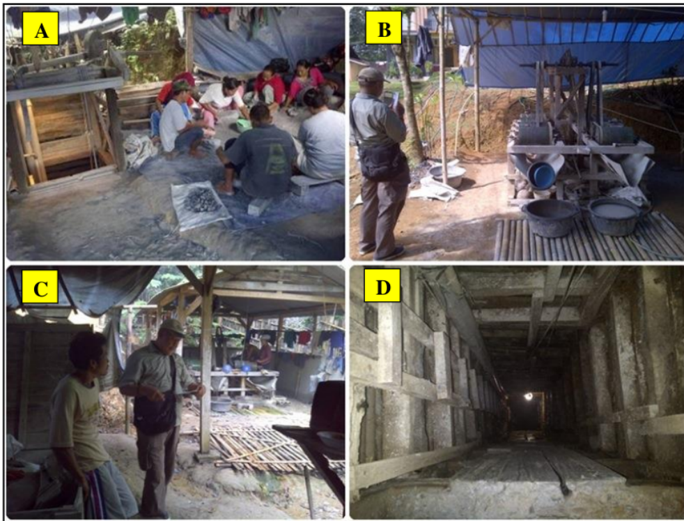
Foto 1.4. Lokasi tambang emas rakyat aktif di Desa Paningkaban, merupakan sumber pendapatan penduduk lokal. Pekerja memilah batu yang mengandung mineral pembawa emas (A), Pengolahan emas dengan rangkaian “mesin gelondong” yang dipergunakan untuk memisahkan mineral emas dengan pengotornya (B), Mendata keterangan yang diberikan oleh pemilik lubang tambang bawah permukaan dalam mencari jalur (urat kuarsa) membawa mineralisasi emas (C), Lubang tambang bawah permukaan sampai mencapai kedalaman vertikal 40 meter, yang kemudian diteruskan lubang horisontal ke arah relatif N300°E (D).
