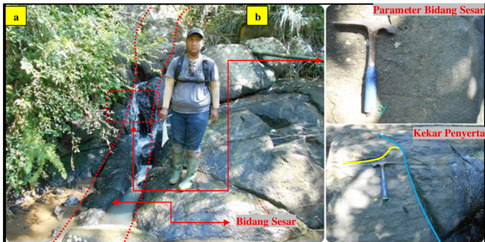
Foto 4.24. Kenampakan bukti keberadaan sesar Banyumas 2 berupa bidang sesar pada lokasi pengamatan 79 koordinat: (X: 281019, Y: 9181780, Eleveasi 226 Mdpl), arah kamera: singkapan bidang sesar N 345^{\circ} E (a), parameter bidang sesar N 346^{\circ} E (b).
