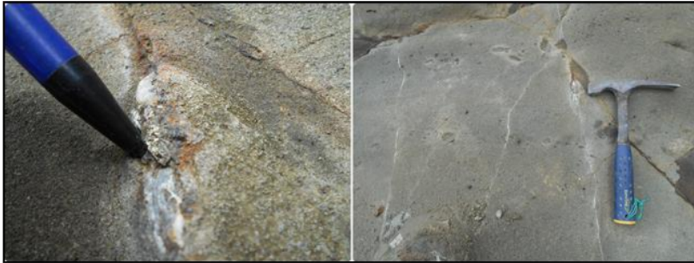
Foto 5.7. Kenampakan urat tarikan ( vein tension ) yang berjenis urat kuarsa ( quartz vein ) yang telah mengalami/termineralisasi dengan keterdapatan unsur mineral bijih logam berupa kalkopirit, pirit pada lokasi pengamatan LPS.013 (Koordinat: X: 279666, Y: 9180616, Elevasi 148 m), Arah foto; singkapan N 290 0 E, parameter N 315 0 E.
