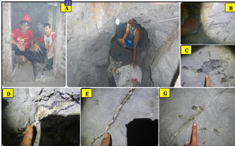
Foto 4.12. Kenampakan foto ciri litologi intrusi andesit didalam tambang emas masyarakat Desa Paningkaban dengan kedalaman \pm 37\text{m} yang telah teralterasi penuh (A), urat kuarsa yang terdapat pada tubuh intrusi dijumpai keterdapatan mineral-mineral bijih berupa: pirit, kalkopirit, galena, bornit (B,D,F,G), dan penjumpaan xenolith batupasir yang telah berubah menjadi meneral lempung kaolin secara penuh pada tubuh batuan intrusi (c) pada lokasi pengamatan 145 koordinat: (X: 279102, Y: 9179912, Elevasi: 219 meter), arah kamera: singkapan N 330^0 E (A), parameter litologi batuan \pm N 335^0 E (B,C,D,E,F,G).
