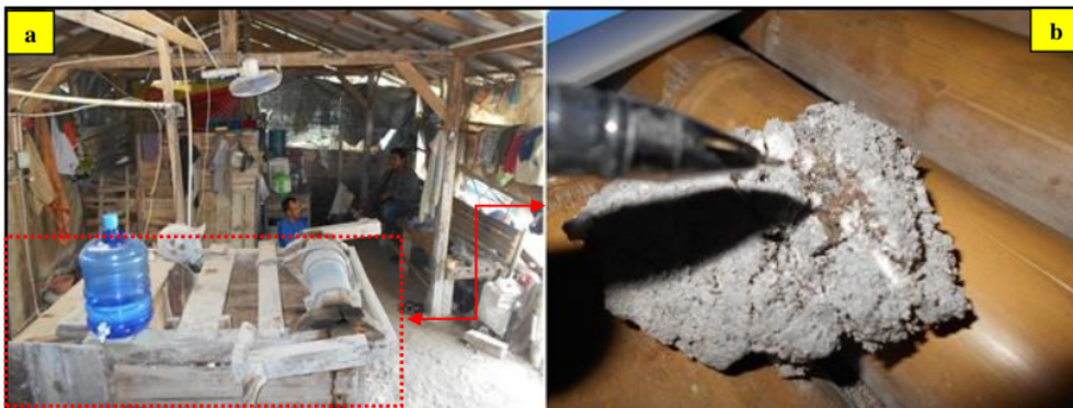
Foto 6.3. Kenampakan sumur sebagai tempat lokasi pengamatan sample analisis AAS LP 45, koordinat: (X: 279105, Y: 9180083, Elevasi 232 Mdpl) yang memiliki kadar mineral bijih aurum/gold (Au) yaitu 4440 ppm , (a), kenampakan foto parameter sample batuan dengan keterdapatan mineral-mineral pirit, galena pada tubuh urat kuarsa ( quartz vein ) (b).
