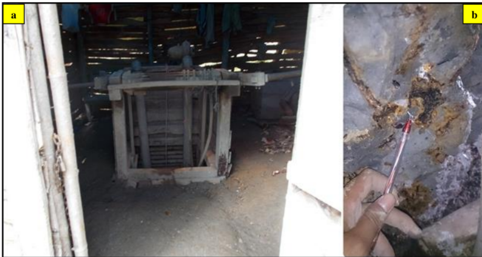
Foto 6.4. Kenampakan sumur sebagai tempat lokasi pengamatan sample analisis AAS LP 24, koordinat: (X: 279081, Y: 9180007, Elevasi 246 Mdpl) yang memiliki kadar mineral bijih aurum/gold (Au) yaitu 3688 ppm , (a), kenampakan foto parameter sample batuan dengan keterdapatan mineral pirit, galena dan magnetit? pada tubuh urat kuarsa ( quartz vein ) (b).
