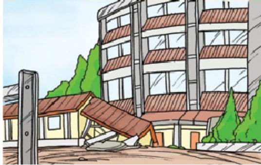
Gambar 3.5. Bangunan yang mengalami liquefaction akibat gempa bumi
