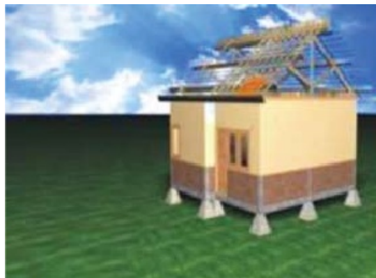
Gambar 3.7. Struktur Bangunan Tahan Gempa
