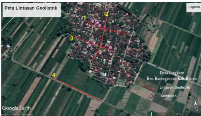
Gambar 11. Lintasan Pengukuran Geolistrik Resistivitas
