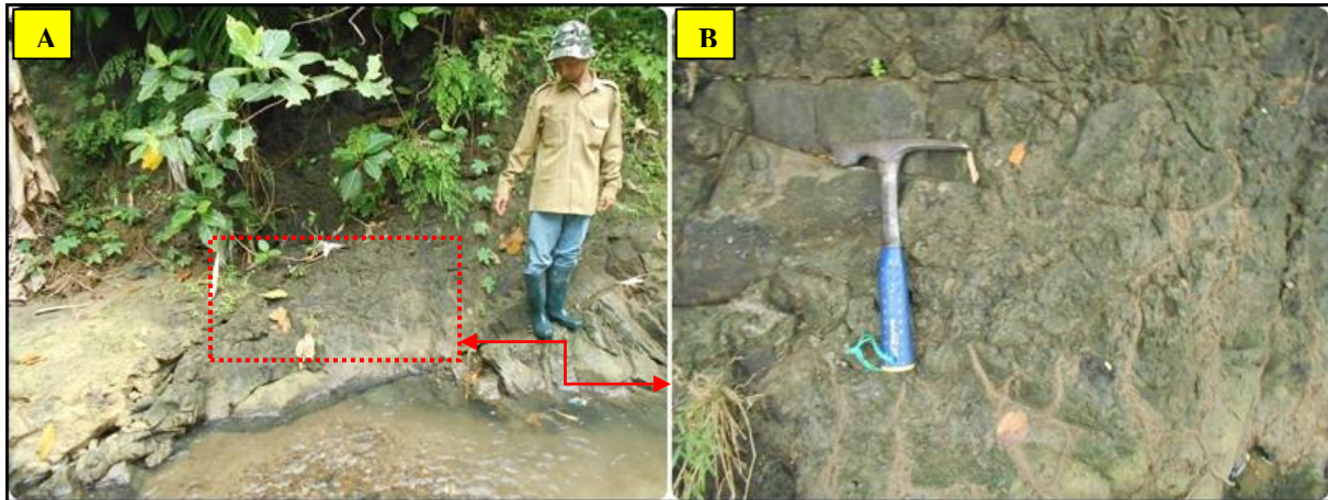
Foto 4.14. Kenampakan ciri litologi satuan batupasir Tapak berstruktur perlapisan dengan kedudukan N 290° E / 24° pada lokasi pengamatan 55 koordinat: (X: 281494, Y: 9179237, Elevasi: 139 meter), arah kamera: singkapan N 101° E (a), parameter litologi batuan N 091° E (b).
