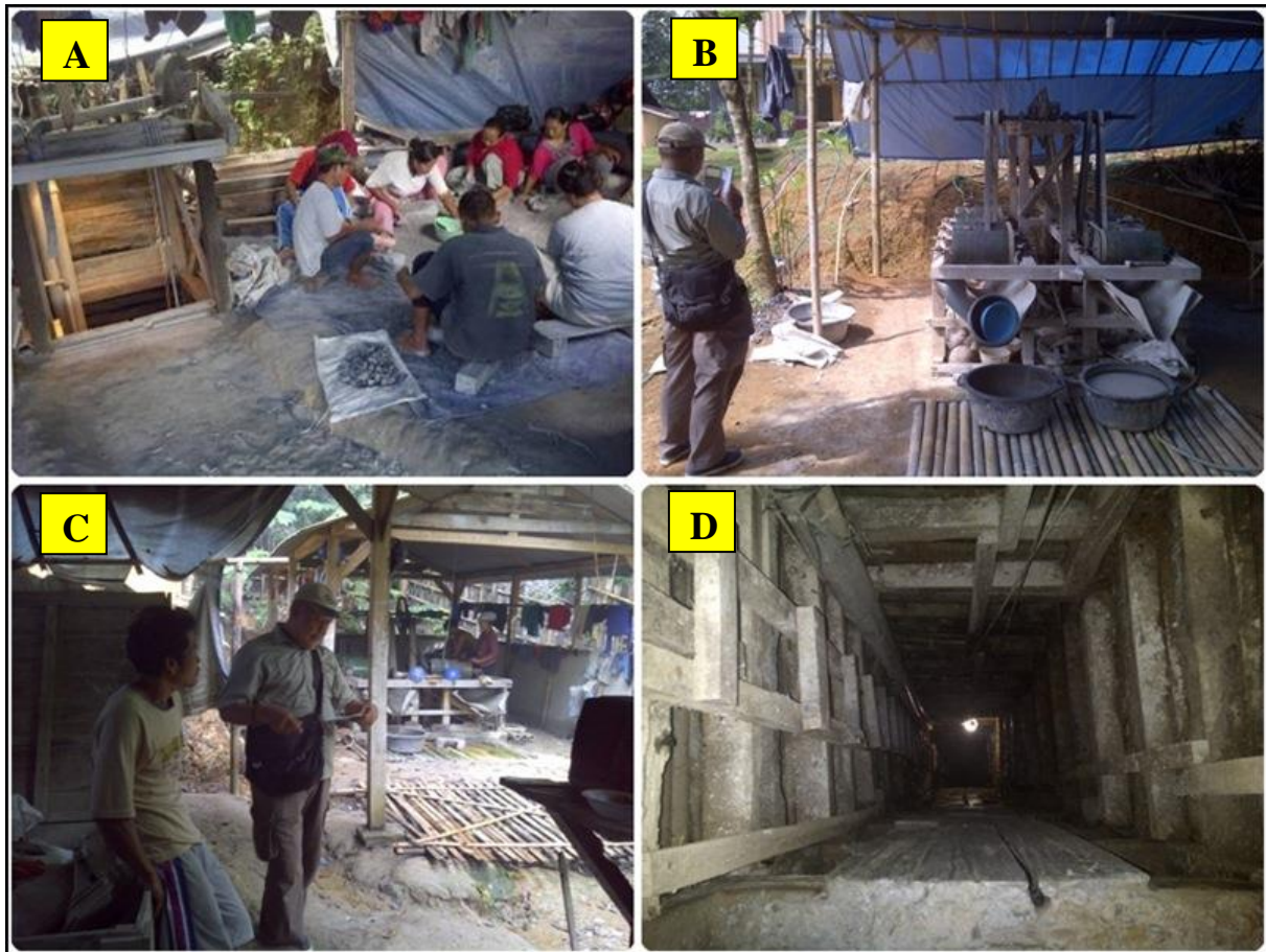
Foto 1.4. Lokasi tambang emas rakyat aktif di Desa Paningkaban, merupakan sumber pendapatan penduduk lokal. Pekerja memilah batu yang mengandung mineral pembawa emas (A), Pengolahan emas dengan rangkaian “mesin gelondong” yang dipergunakan untuk memisahkan mineral emas dengan pengotornya (B), Mendata keterangan yang diberikan oleh pemilik lubang tambang bawah permukaan dalam mencari jalur (urat kuarsa) membawa mineralisasi emas (C), Lubang tambang bawah permukaan sampai mencapai kedalaman vertikal 40 meter, yang kemudian diteruskan lubang horisontal ke arah relatif N300°E (D).
