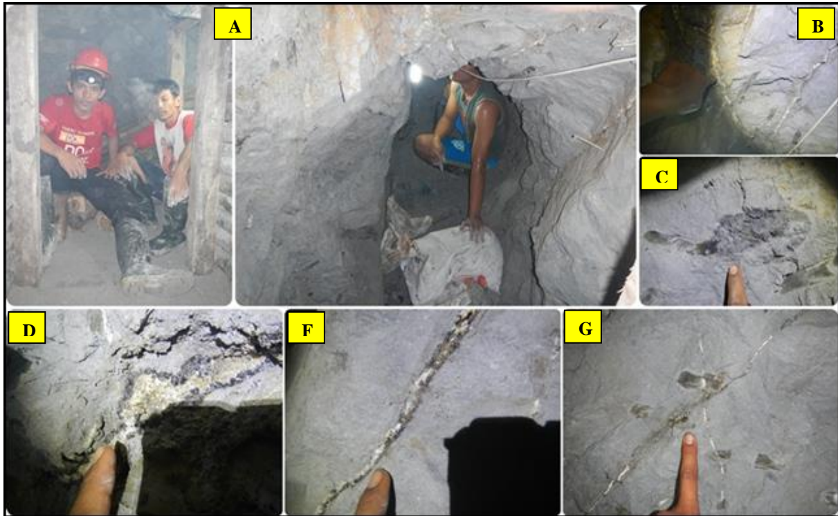
Foto 4.12. Kenampakan foto ciri litologi intrusi andesit di dalam tambang emas masyarakat Desa Paningkaban dengan kedalaman ± 37m yang telah teralterasi penuh (A), urat kuarsa yang terdapat pada tubuh intrusi dijumpai keterdapat mineral-mineral bijih berupa: pirit, kalkopirit, galena, bornit (B,D,F,G), dan penemuan xenolith batupasir yang telah berubah menjadi mineral lempung kaolin secara penuh pada tubuh batuan intrusi (C) pada lokasi pengamatan 145 koordinat: (X: 279102, Y: 9179912, Elevasi: 219 meter), arah kamera: singkapan N 330 0 E (A), parameter litologi batuan ± N 335 0 E (B,C,D,E,F,G).
