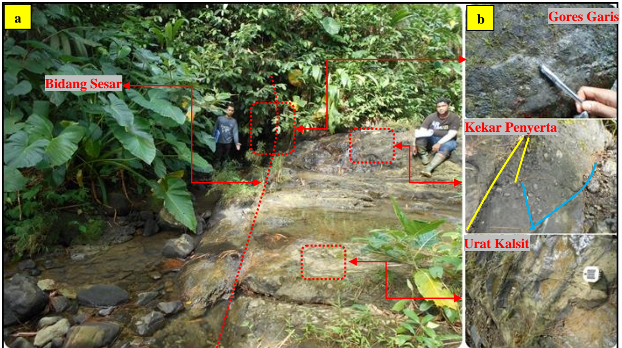
Foto 4.18. Kenampakan bukti keberadaan sesar Lumbir 2 pada lokasi pengamatan 72 koordinat: (X: 275385, Y: 9179164, Eleveasi 262 Mdpl), arah kamera: singkapan bidang sesar N 004 0 E (a), parameter gores garis, kekar penyerta, dan urat kalsit N 358 0 E (b).
