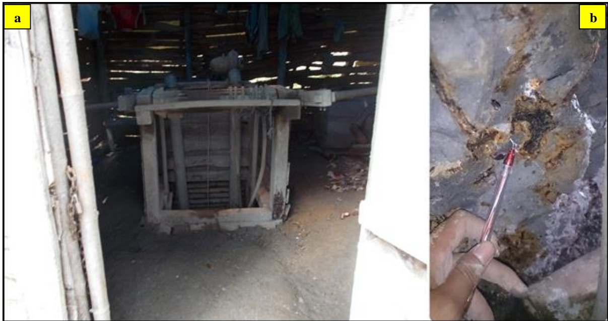
Foto 6.4. Kenampakan sumur sebagai tempat lokasi pengamatan sample analisis AAS LP 24, koordinat: (X: 279081, Y: 9180007, Elevasi 246 Mdpl) yang memiliki kadar mineral bijih aurum/gold (Au) yaitu 3688 ppm , (a), kenampakan foto parameter sample batuan dengan keterdapatannya mineral pirit, galena dan magnetit? pada tubuh urat kuarsa ( quartz vein ) (b).
