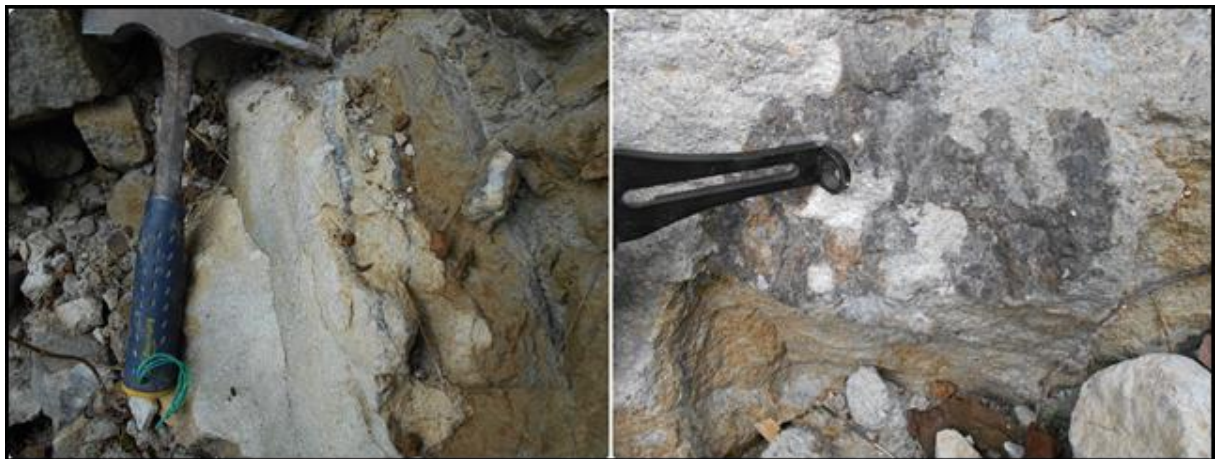
Foto 5.6. Kenampakan urat tarikan ( vein tension ) yang berjenis urat kuarsa ( quartz vein ) yang telah mengalami/termineralisasi dengan keterdapatan unsur mineral bijih logam berupa galena, kalkopirit, pirit pada lokasi pengamatan LPS.09 (Koordinat: X: 278872, Y: 9179848, Elevasi 160 m), (b). Arah foto; singkapan N 160 0 E, parameter N 141 0 E.
