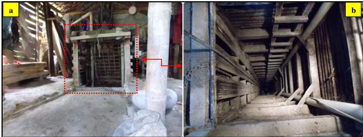
Foto 6.2. Kenampakan sumur sebagai tempat lokasi pengamatan sample analisis AAS LP 22, koordinat: (X: 279109, Y: 9179960, Elevasi 242 Mdpl) yang memiliki kadar mineral bijih aurum/gold (Au) tertinggi yaitu 4755 ppm , (a), kenampakan foto lubang sumur tambang emas (b).
