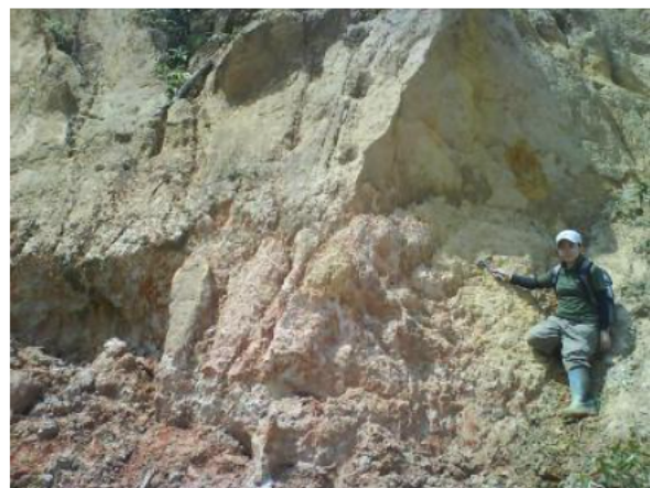
Gambar 3.4 Pada lokasi LP01 (kiri) di daerah Air Raru, terdapat singkapan batupasir kasar, di sekitarnya banyak kolong bekas tambang rakyat yang ditinggalkan penambang. Daerah Air Ketutu LP34 (kanan) terdapat singkapan batupasir kasar, putih keabuan, setempat menunjukkan mineral kaolin, merah kecoklatan menunjukkan mineral oksida hadir sebagai fragmen selain mineral kuarsa.
