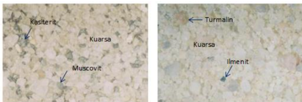
Gambar 4.1. Mineral yang hadir kasiterit, ilmenit, zircon, turmalin, muskovit dan mineral kuarsa pada I P29 (kiri) dan I P01 (kanan)
