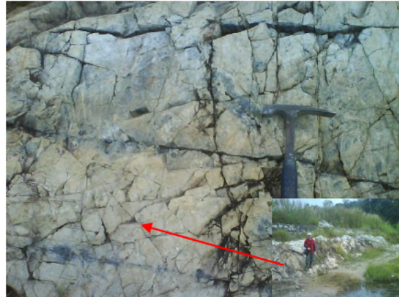
Gambar 3.7 Batupasir tersilisifikasi dengan kekar kompresi N 120^{\circ} - 130^{\circ}E/70^{\circ} dan kekar gerus N 030^{\circ} - 040^{\circ}E/70^{\circ} di daerah Desa Nyelanding pada LP20.
