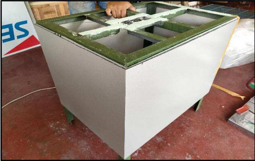
Gambar 19. Dinding alat TTG menggunakan aluminium
