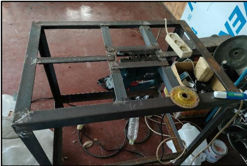
Gambar 16. Kerangka mesin TTG untuk pemotong
