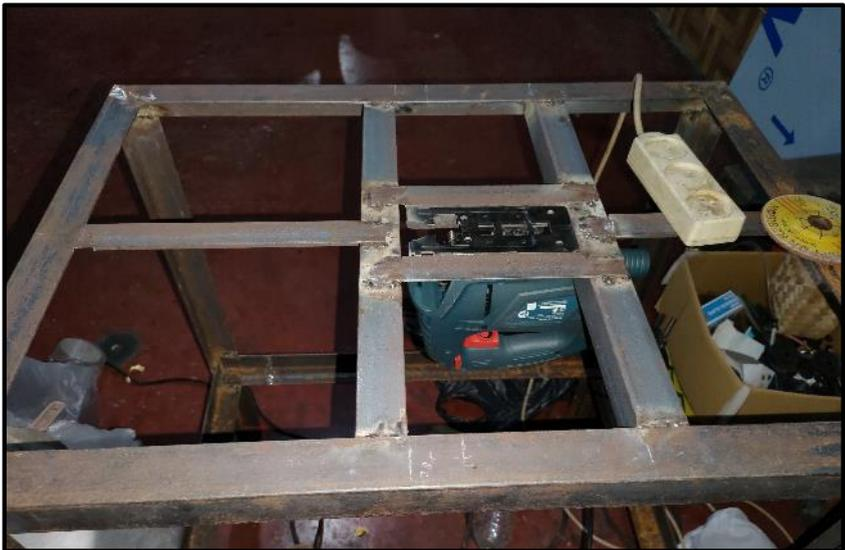
Gambar 18. Pemasangan mesin *Jigsaw* pada kerangka
