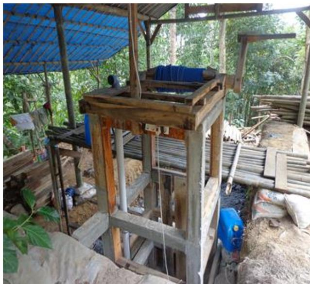
Gambar 2. Lubang Bukaan Vertikal (*Shaft*)
