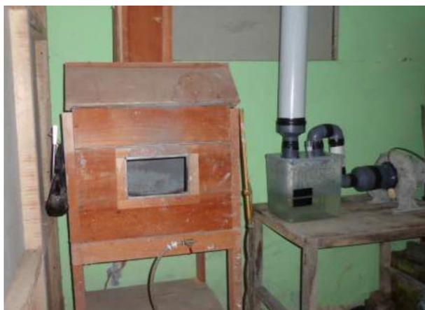
Gambar 5. Alat Destilasi (Retort) untuk Menangkap Kembali Uap Merkuri
