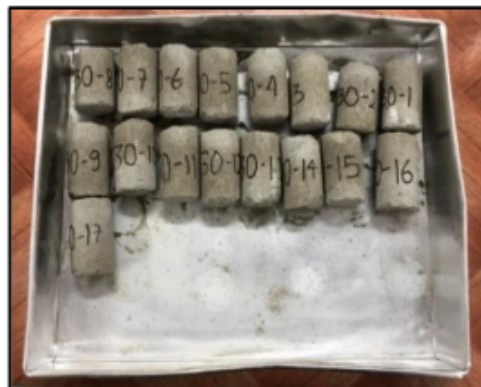
Gambar 3.8. Sampel Artificial Core dengan Pasir Kwarsa Ukuran Mesh 30
