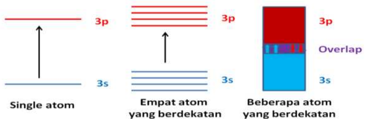
Gambar 2. Pita Energi dan Energy Gap Pada Material Logam
