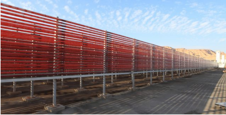
Gambar 4. Sistem budidaya alga. (a) Sistem tertutup jenis raceway pond system milik Cyanotech; (b) Sistem tertutup jenis fotobioreaktor milik Algatech (cyanotech.com, foodnewsinternational.com).
