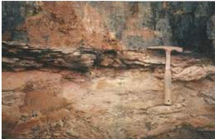
**Gambar 9.** Batas tegas antara *levee deposits* dengan *overbank deposits*
