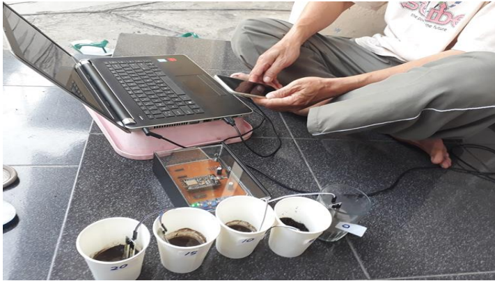
Gambar 1. Komponen dari IoT: laptop, Hp, Server, Sensor kelembaban
