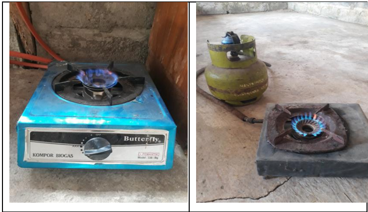
Gambar 1. Kompor menyala dari biogas dan gas Elpiji
