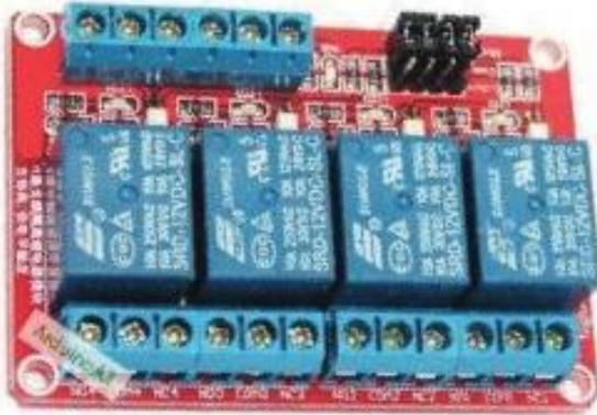
Gambar 10. Perangkat *Relay Control*
