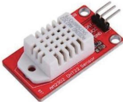
Gambar 9. Perangkat Sensor Kelembapan dan Suhu Udara
