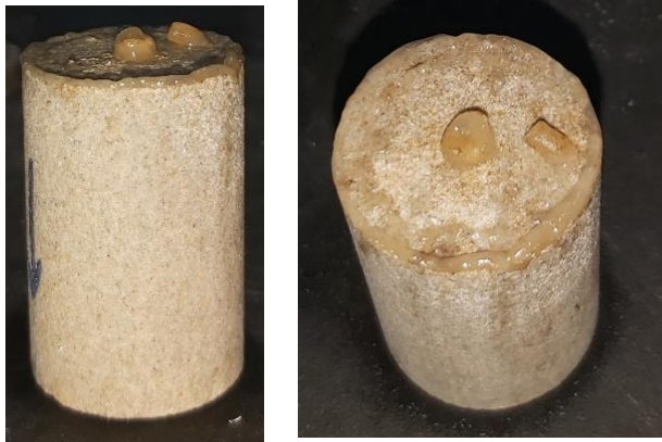
Gambar 5.2. Kondisi Core Setelah Injeksi
