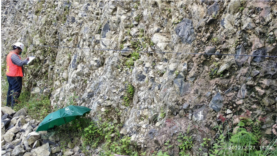
Gambar 3. Foto pengukuran karakteristik kekar pada salah satu scanline di lapangan.
