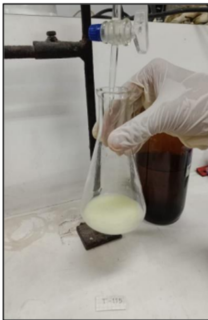
Gambar IV.3. Pengujian Kadar Klorida (Cl) Air Formasi
