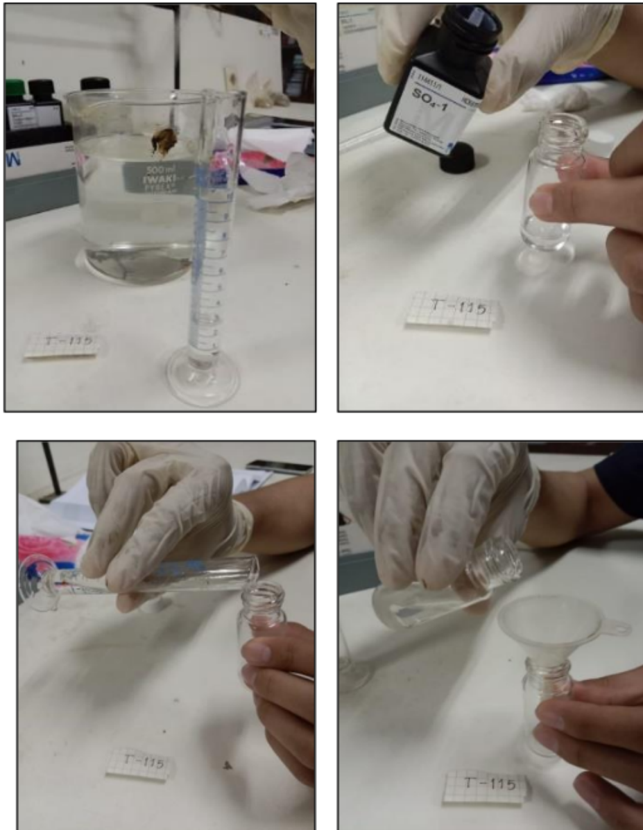
Gambar IV.4. Pengujian Kadar Sulfat Air Formasi
