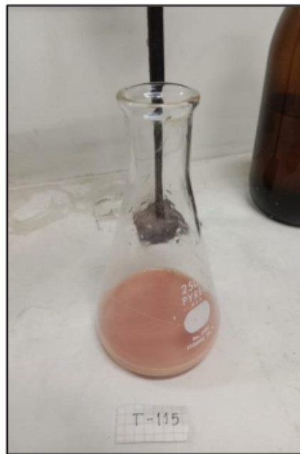
Gambar IV.3. Pengujian Kadar Klorida (Cl) Air Formasi
