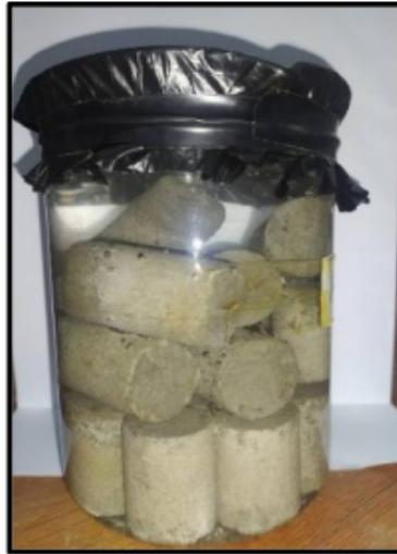
**Gambar 4. 10. Proses Perendaman Core dengan Air Formasi**
