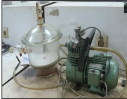
Gambar 4. 13. *Vacuum Desikator* dan *Vacuum Pump*
