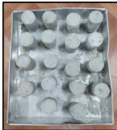
**Gambar 4. 9 Campuran Pasir Kwarsa, Semen, dan Air di dalam Cetakan Pipa Paralon**
