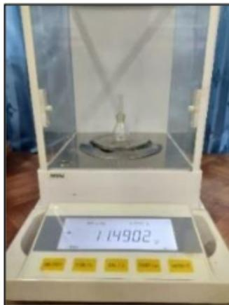
**Gambar 6. 7. Piknometer 10 ml dan Timbangan Digital**
