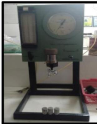
Gambar 4. 15. Gas Permeameter
