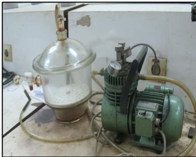
Gambar 4. 13. *Vacuum Desikator* dan *Vacuum Pump*
