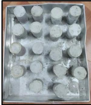
**Gambar 4. 16. Artificial Core yang Telah Dikeringkan**
