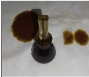
**Gambar 6. 8. Piknometer yang Diisi Crude Oil**
