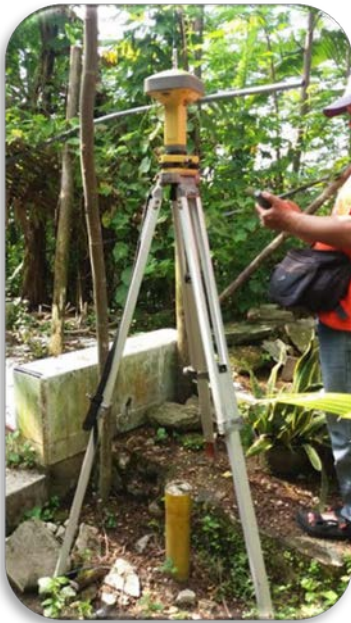
Gambar 14. Dokumentasi kegiatan pengukuran dengan menggunakan GPS Geodetik merk TopCon di Clapar Banjarnegara pada kala kesatu hingga kala keempat
