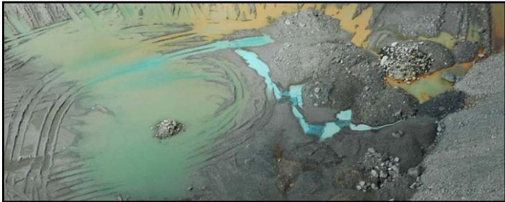
Air Asam Batuan (Acid Rock Drainage–ARD) di Grasberg. Air yang berwarna mengindikasikan hasil oksidasi dari tembaga (biru/hijau) dan besi (coklat kemerahan) dalam batu buangan yang mengandung chalcopyrite dan pyrite yang terkandung dalam limbah batuan (MoE 2006)
