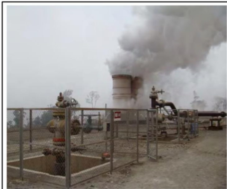
Gambar 1-6 Pelepasan uap ke atmosfer melalui cerobong AFT
