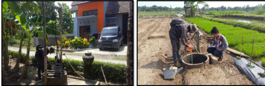
Gambar 3. Pengambilan data kedalaman airtanah pada sumur di permukiman penduduk
