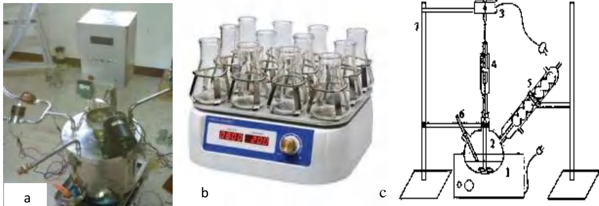
Gambar 8. Alat utama produksi hidrogen: (a) Biorektor, (b) Shaker incubator, (c) Alat ekstraksi dan hidrolisis
