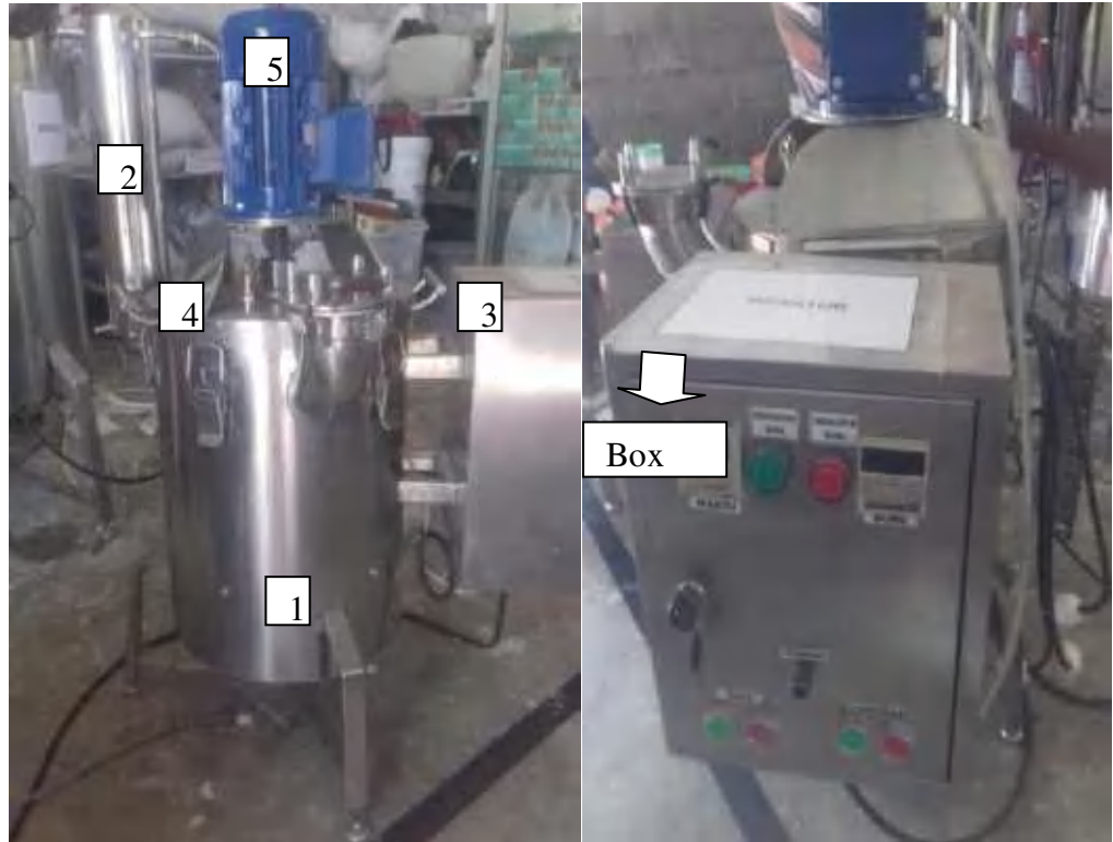
Gambar 1. Reaktor distilator: (1) Tabung reaktor,(2) Kondensor, (3) Box kontrol, (4)Lubang outlet/inlet, (5) Motorpengaduk, (6) box pengendali suhu, waktu dan kecepatan pengaduk.
