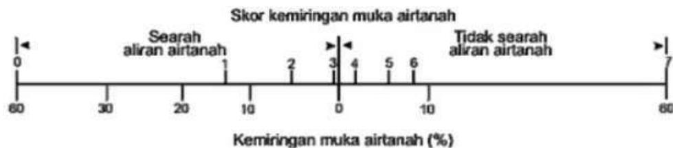
Gambar 3.2 Diagram Kemiringan Muka Airtanah
