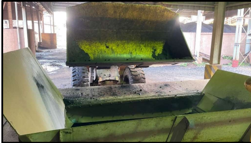
Gambar 4.1 Pemuatan Raw Coal ke Hopper
