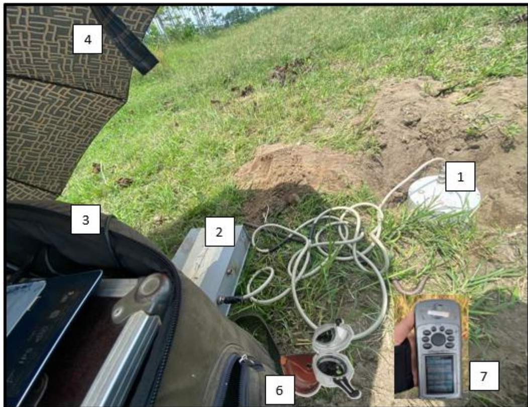
Gambar 4.3 Peralatan dan Perlengkapan Metode Mikroseismik
