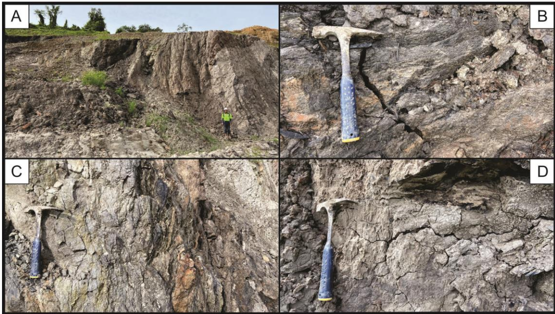
Gambar 4.28. Singkapan Satuan batupasir Warukin LP 82, azimuth foto N 226° E. Batulempung berstruktur masif dengan kongresi siderite (B). Batupasir dengan sisipan batupasir (C). Batulempung sisipan batulanau (D).
